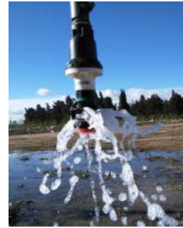
Boquilla de baja presión instalada en pivot - Pruebas de diseño
