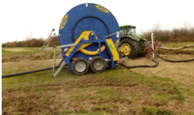
Una pompa azionata dal cardano alimenta il rotolone che a sua volta trasporta i reflui fino all'attrezzo.
