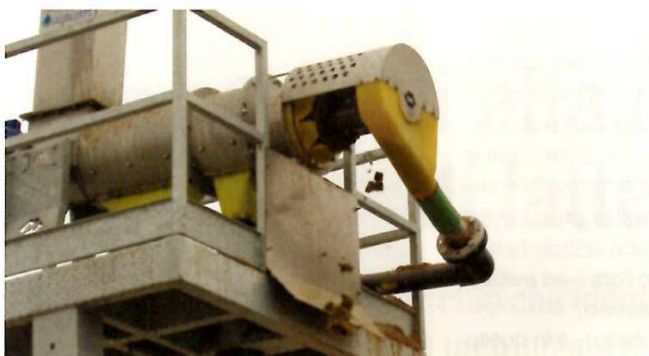
Il separatore di Acquaferter effettua una doppia spremitura: verso l'esterno e anche verso l'interno, grazie alla coclea forata. Si ottiene così un separato solido al 35% circa di sostanza secca.
