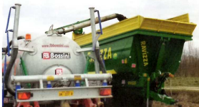
Carri-botte riforniscono con regolarità il carro-cisterna principale, assicurando una costante presenza di materiale da interrare.
