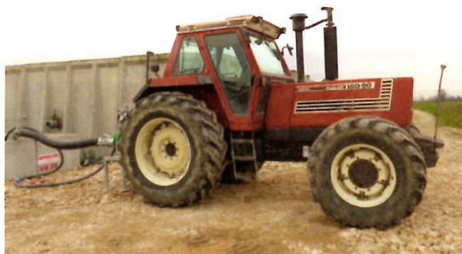
Un sistema composto da una piccola vasca di pescaggio e da una pompa alimentata da un vecchio trattore permette di inviare i reflui alla rete di distribuzione interrata e, da questa, agli attrezzi impegnati nello spandimento in campo.
