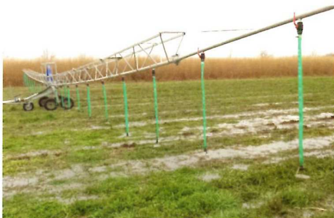
Un'ala piovana da 34 metri agganciata a un normale irrigatore permette di distribuire reflui sia su terreno nudo sia con mais già alto. Le calate sono infatti collocate a 1,4 metri di distanza, in modo da coincidere con l'interfila delle piante.
