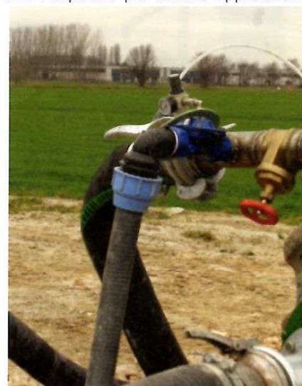
Un semplice sistema idraulico avvia il ricircolo del liquido nella vasca di pescaggio non appena l'attrezzo in campo interrompe la distribuzione. In questo modo si evita un sovraccarico di pressione sulla pompa.
